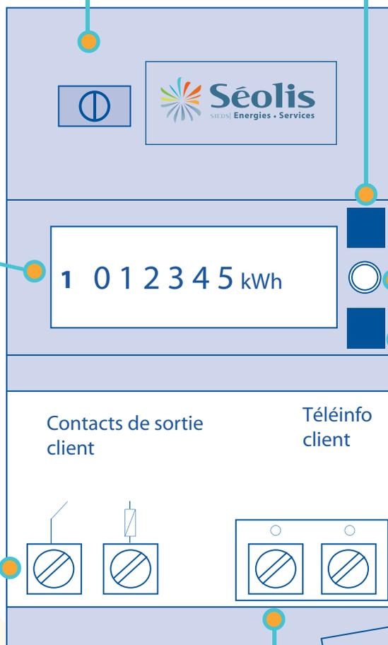
Votre compteur électronique garde en mémoire et tient à votre disposition plusieurs indications. Pour faire apparaître l'information recherchée, il suffit d'appuyer une ou plusieurs fois sur les touches S et D.
